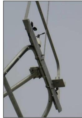
Photo 68 : Exemple d'anémomètre et girouette sur nacelle (Source : The Wind Power)
