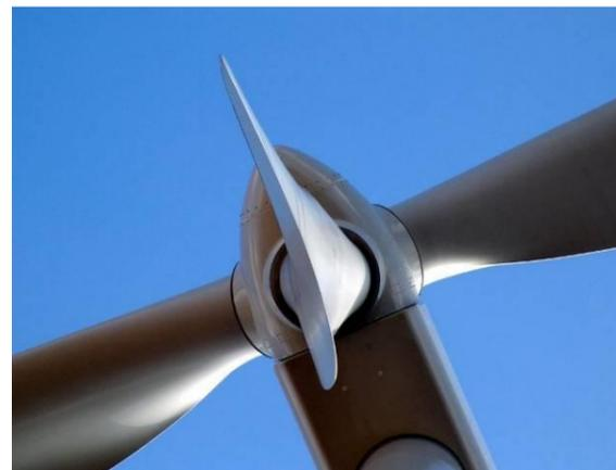
Photo 79 : Annulation de la portance des pales d'éolienne par "mise en drapeau" (Source : Larousse.fr)
