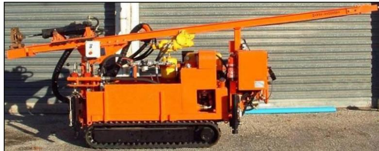
Photo 73 : Sondeuse de type wagon drill hydraulique (Source : FONDASOL)
